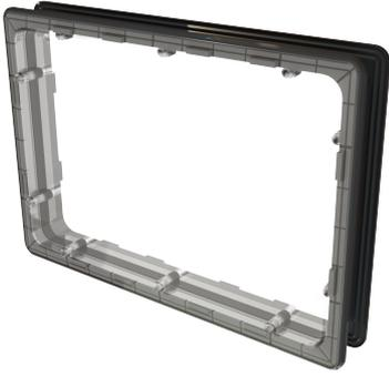
Fenêtre d'inspection rectangulaire en polycarbonate transparent. Destiné aux installations CVC utilisant des portes isolées. Utilisé pour le contrôle visuel des processus pendant que l'unité est en plein fonctionnement. La fenêtre est équipée de joints des deux côtés et convient aux unités à pression positive ou négative. Montage simple à l'aide de dix vis autotaraudeuses d'un seul côté. Les vis de montage sont fournies avec le produit.
